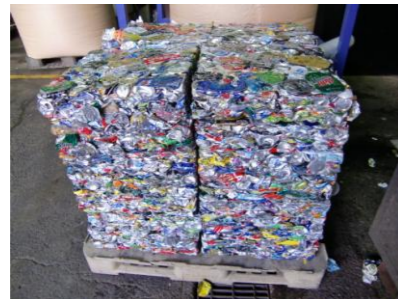
アルミセパレーターにてアルミ缶を選別し圧縮機にてプレス加工
