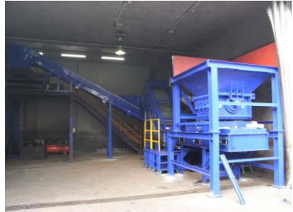
袋入りのビン・缶・PETを破袋機にて破袋し中二階選別ラインに搬送
