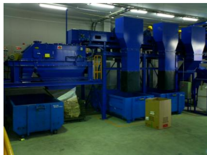
アルミセパレーターにてアルミ缶を選別し圧縮機にてプレス加工
