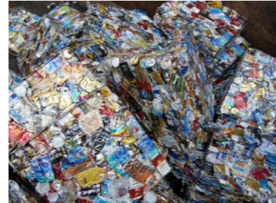
磁選機にてスチール缶を選別し圧縮機にてプレス加工
