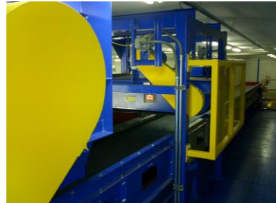
磁選機にてスチール缶を選別し圧縮機にてプレス加工
