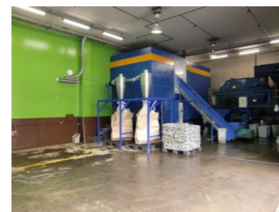
PETを破砕・洗浄しフレコンバッグにて収納
