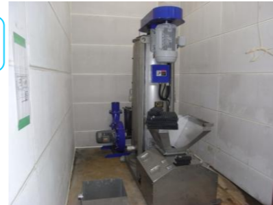
PETを破砕・洗浄しフレコンバッグにて収納
